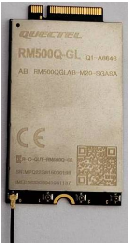
Figure 2-4 5G Module RM500Q-GL
